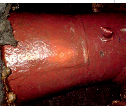
Рис. 2. Состояние поверхности после 2,5 лет эксплуатации
